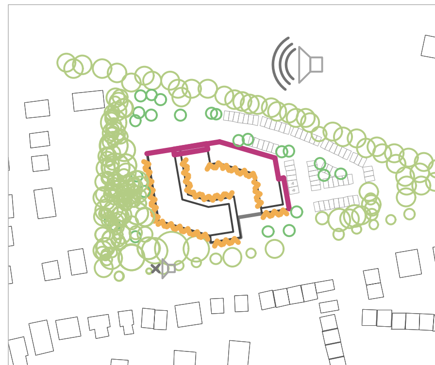
Schallschutz_ Erschliessung reagiert auf Lärm / Orientierung der Wohnungen / Schallschutzwand
