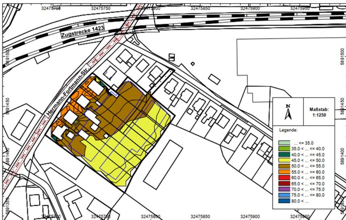
Immissionsraster Verkehrslärm in 5 m über GOK, nachts (mit Bestandshäuser in erster Baureihe)
