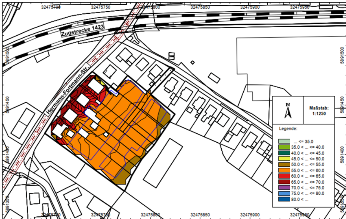
Immissionsraster Verkehrslärm in 5 m über GOK, tags (mit Bestandshäuser in erster Baureihe)
